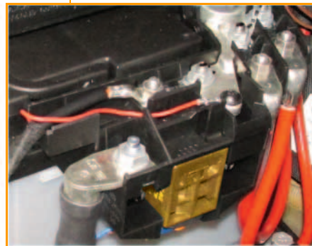
Hauptsicherungsbox mit Sicherungshalter SD, Pluspolklemme und Batterietrennschalter J990
