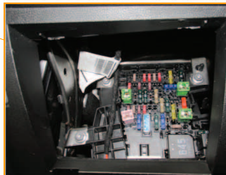
Relais- und Sicherungshalter SC im Fahrgastraum links unten, hinter dem Ablagefach
