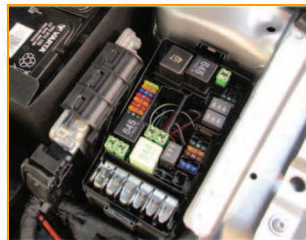
E-Box mit Relais- und Sicherungshalter SB und Multifuse-Vorsicherungshalter SA
