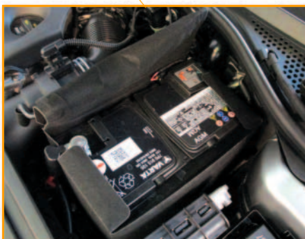
12V-Batterie im Motorraum Bei Verbau der 12V-Batterie im Motorraum entfällt die 12V-Batterie im Kofferraum.
